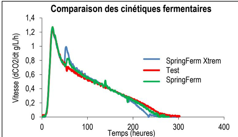
SpringFerm™ Xtrem montre un impact important entre tiers et mi-fermentation sur l'accélération et/ou la finition de la fermentation en comparaison à des levures moins autolysées telles que le SpringFerm™.
